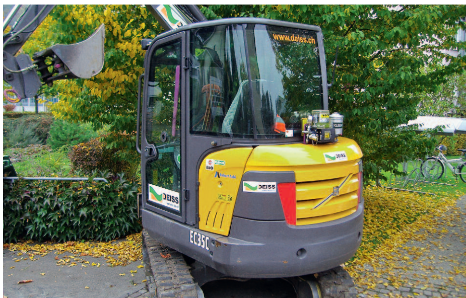
Kein Gebastel auf der Motorhaube, sondern eine sinnvolle, extern im Nebenstrom angebrachte Filteranlage. (Bilder: zvg)
